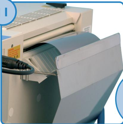
After 5 minutes the processed film will exit into the film collector / Après un délai de 5 minutes, le film développé sortira dans le récepteur du rouleau / Dopo 5 minuti, la pellicola elaborata viene posizionata nel raccoglitore / Nach 5 Minuten wird der verarbeitete Film im Collector herauskommen / Tras 5 minutos, el carrete procesado saldrá del receptor del carrete / Через 5 минут готовый снимок выпадет в лоток
