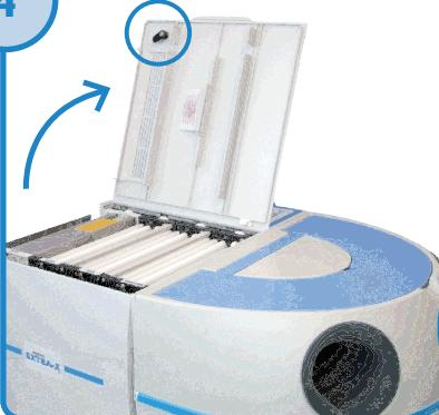
Unlock the lid and open the machine. Remove internal packaging / Débloquez le couvercle et ouvrez la machine. Retirez les emballages internes / Sbloccare il coperchio e aprire la macchina. Rimuovere l'imballaggio interno / Den Deckel entriegeln und das Gerät öffnen. Die interne Verpackung entfernen / Desbloquee la tapa y abra la máquina. Retire los envoltorios internos / Разблокируйте крышку и откройте аппарат. Вытащите находящуюся внутри упаковку
